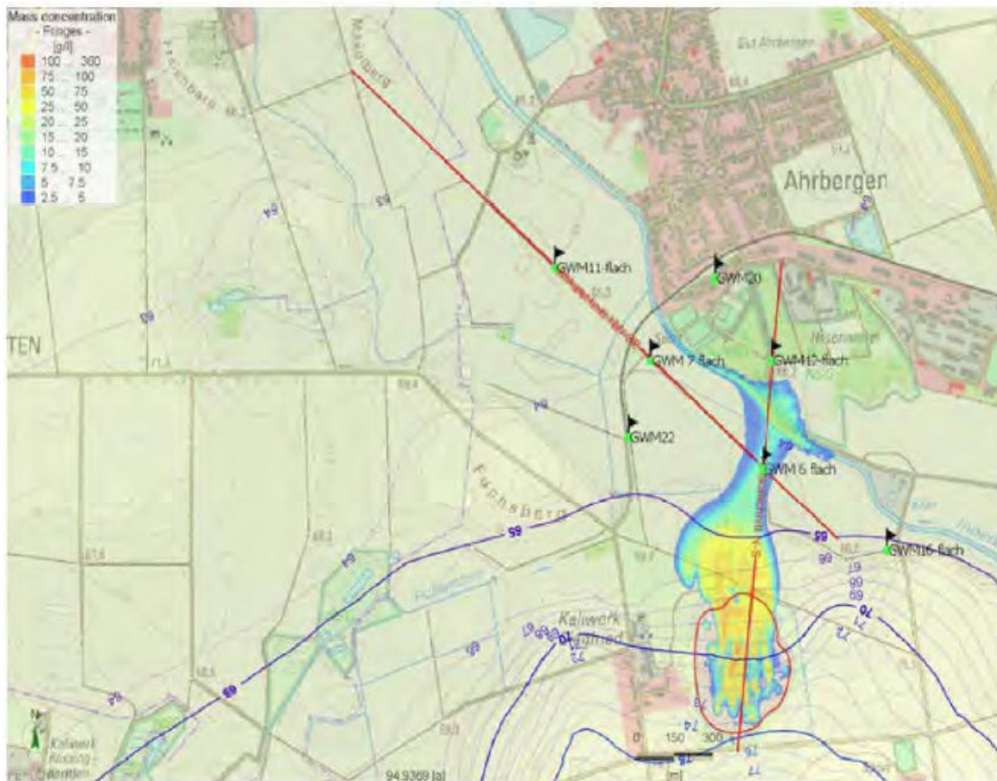
Abb. 45: Horizontalschnitt der modellierten Ausbreitung der Mineralisation ausgehend von der Althalde in etwa 5 m u. GOK im Ist-Zustand
